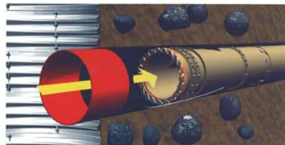
■ 到達後内管引抜状況 (切削ビット交換時・障害物回収時における内管引抜状況)
