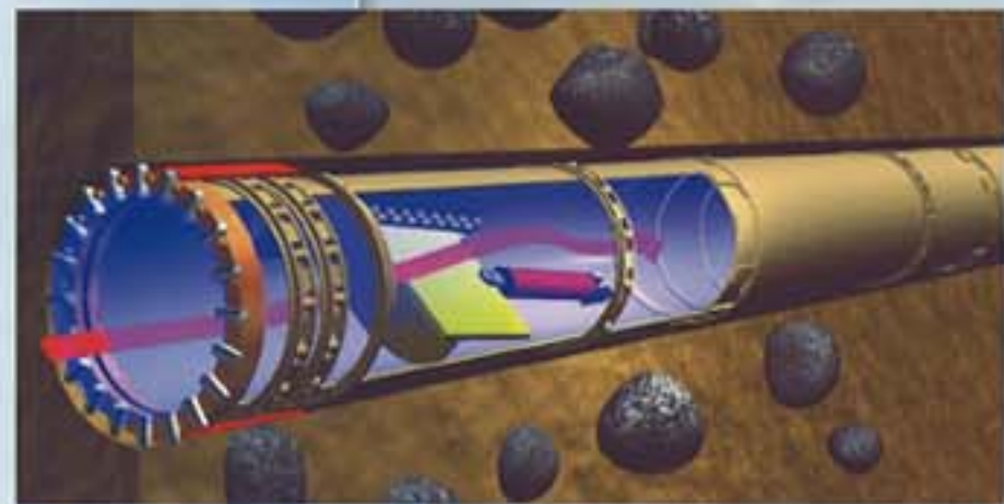
■ 帯水層における取込制御装置を用いた掘削状況
