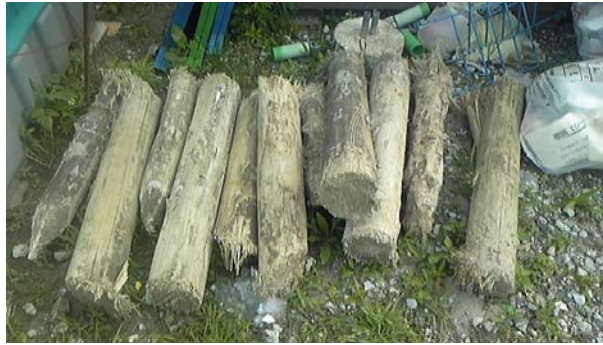
写真一 1 推進中に切削した木杭
